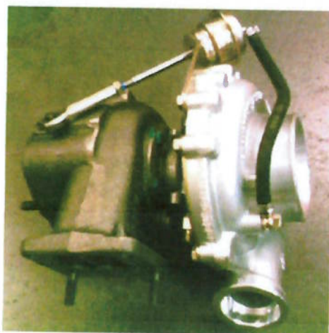
Fig. 5.16: detalhe do flange do turbo-compressor K27.2
